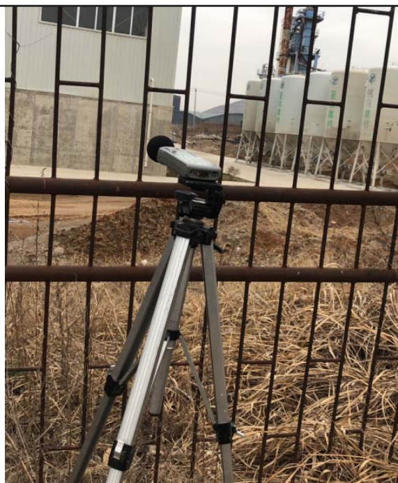
图 6 厂界噪声现场监测照片
