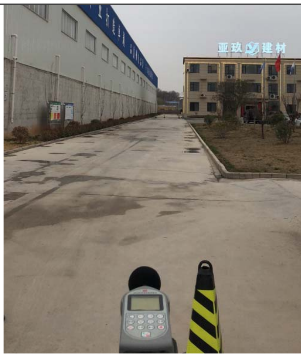
图 6 厂界噪声现场监测照片
