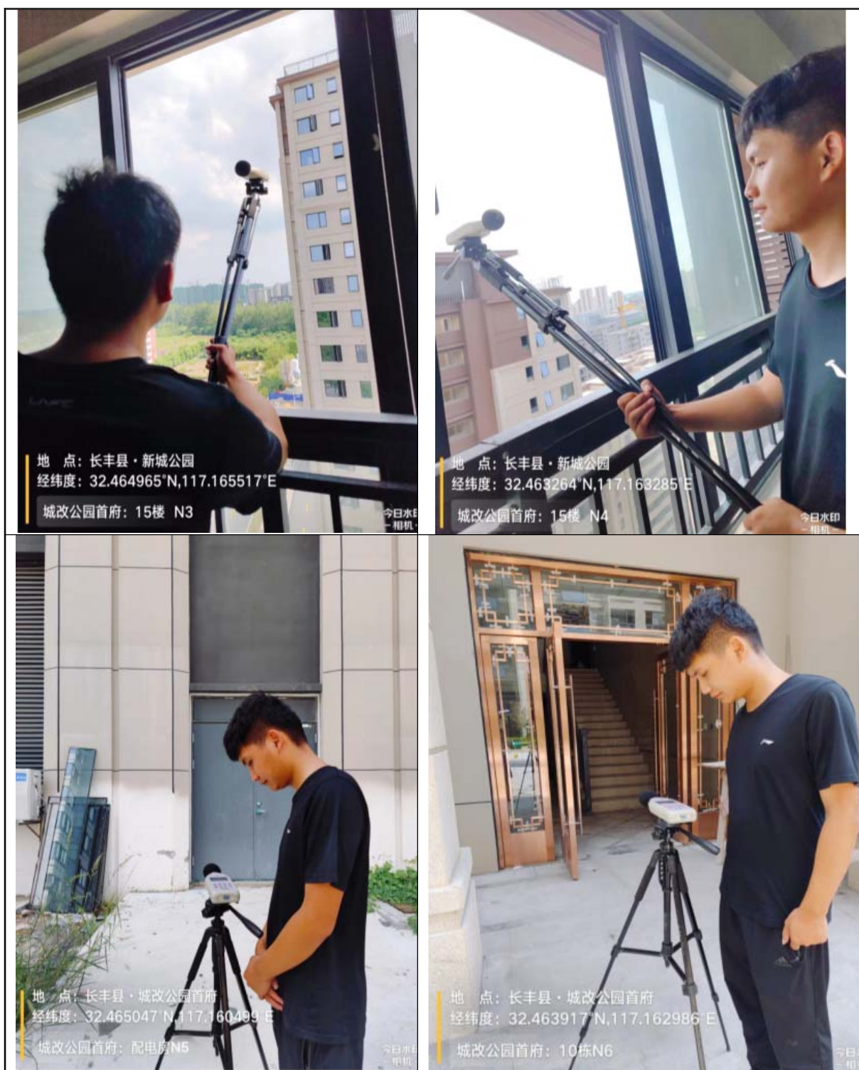
图 7-1 噪声监测照片
